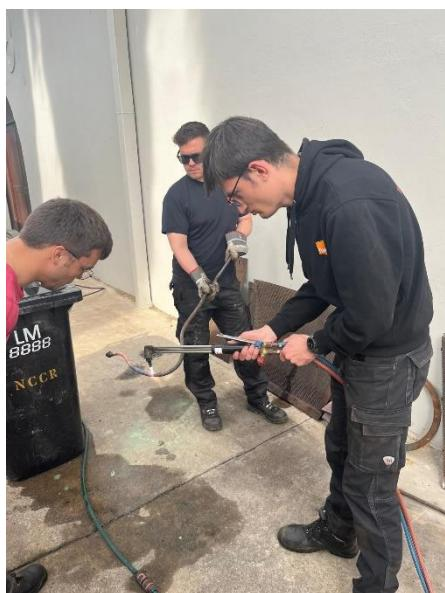
In den nächsten Tagen mussten verschiedene Kupferrohre erhitzt, von Öl befreit und zurechtgebogen werden. Einige dieser Rohre konnten wir anschließend direkt an der Lok anbringen. Außerdem brachten wir die Steuerstangen für den Richtungswender und die Verbindungsstangen vom Regler an.
