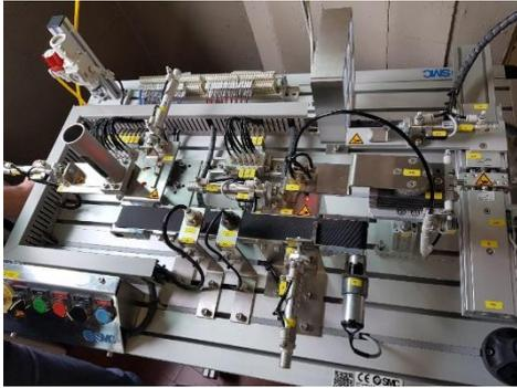
Wir besichtigten auch die Automatisierungstechnik, wo die Schüler\*innen am PC virtuell Leiterplatten bestückten. In der Pneumatik wird am PC mit FLUIDSIM gearbeitet und im Labor stehen Pneumatikübungswände von der Firma FESTO und das Modell einer Sortieranlage für unterschiedliche Werkstücke, die mithilfe von Sensoren in mehreren Magazinen getrennt werden, dienen zur Übung.
